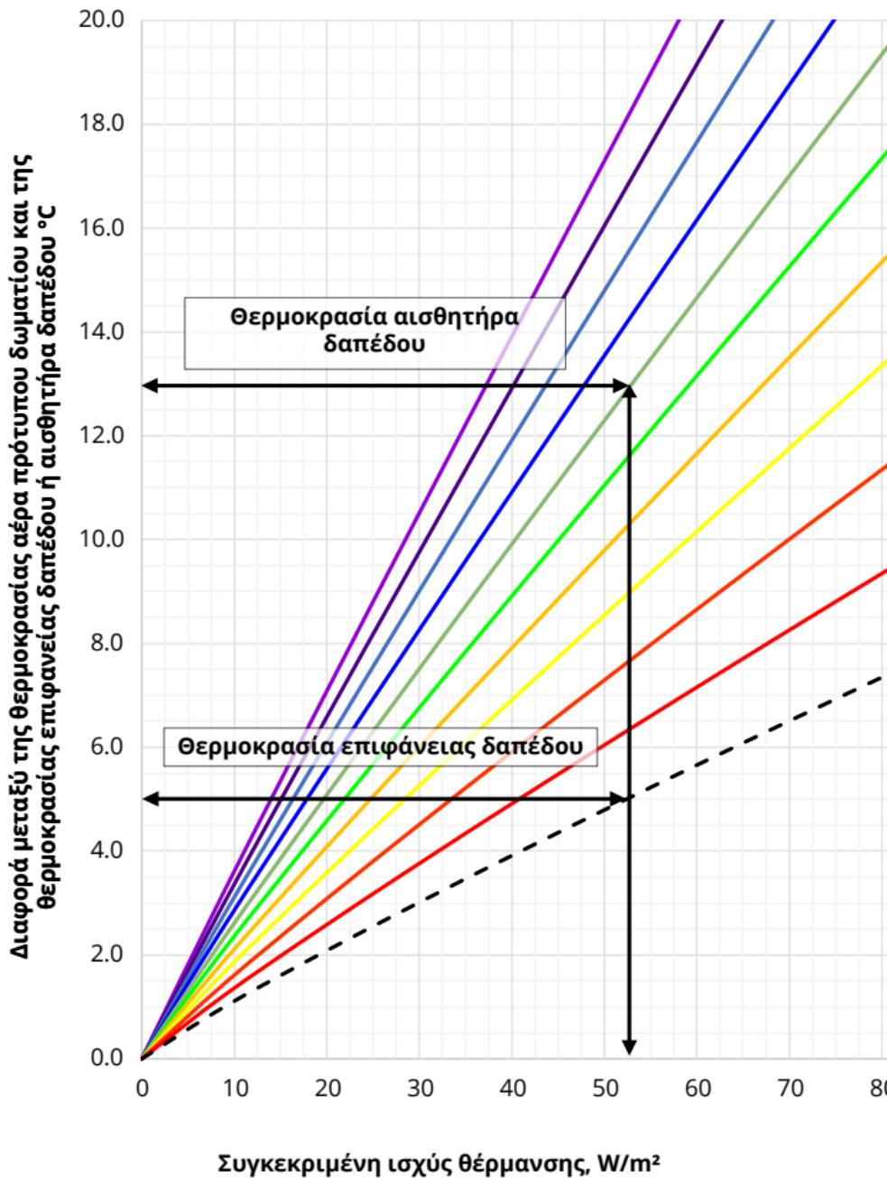
Χρησιμοποιώντας το παραπάνω γράφημα μπορεί κανείς να βρει τη συγκεκριμένη ισχύ θέρμανσης ενός συστήματος ηλεκτρικής ενδοδαπέδιας θέρμανσης βάσει της διαφοράς ανάμεσα στην πρότυπη θερμοκρασία αέρα δωματίου και αυτή της επιφάνειας ή του αισθητήρα δαπέδου για τις διάφορες επενδύσεις δαπέδων.
