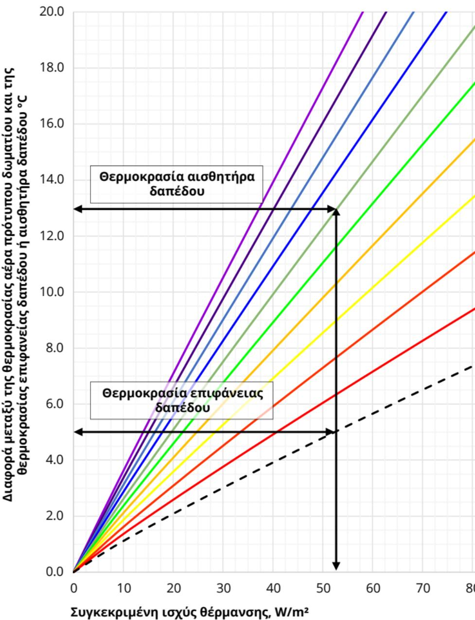
Χρησιμοποιώντας το παραπάνω γράφημα μπορεί κανείς να βρει τη συγκεκριμένη ισχύ θέρμανσης ενός συστήματος ηλεκτρικής ενδοδαπέδιας θέρμανσης βάσει της διαφοράς ανάμεσα στην πρότυπη θερμοκρασία αέρα δωματίου και αυτή της επιφάνειας ή του αισθητήρα δαπέδου για τις διάφορες επενδύσεις δαπέδων.
