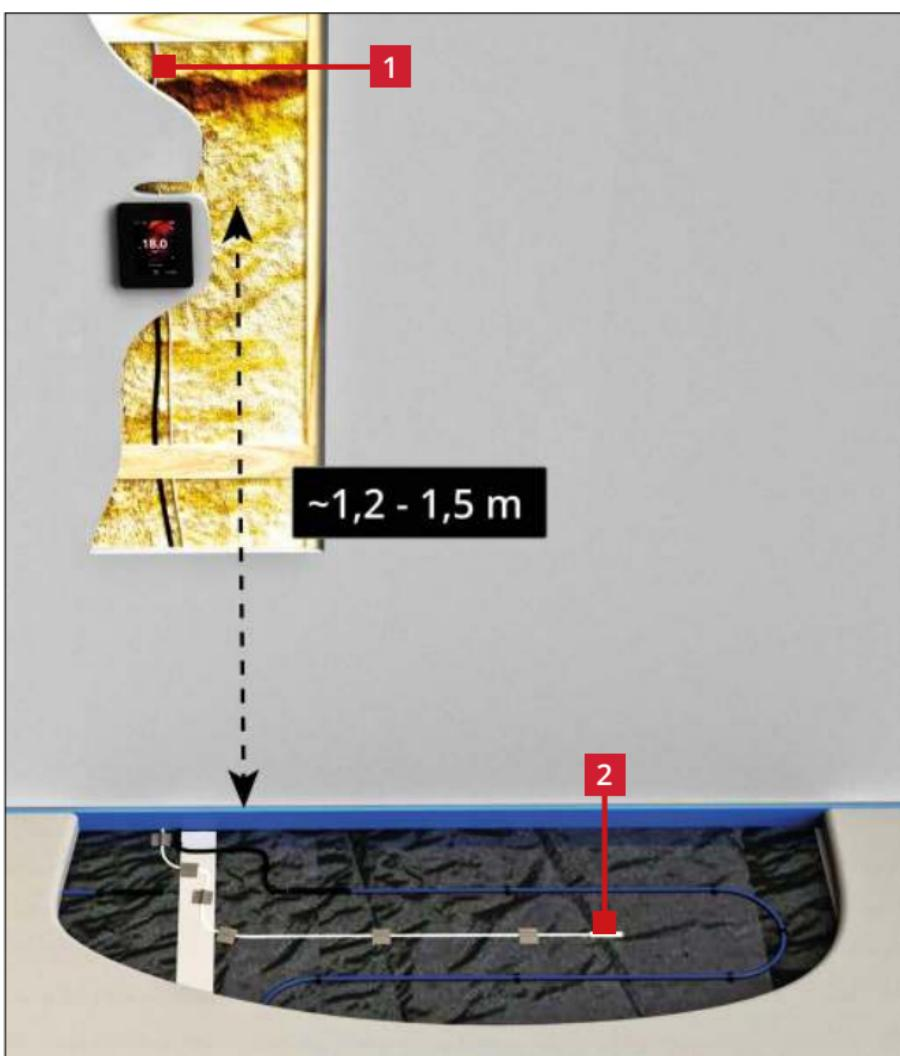
**1** Η παροχή στο θερμοστάτη ΠΡΕΠΕΙ ανά πάσα να προστατεύεται από διακόπτη διαρροής εντάσεως (RCD) ή διακόπτη διαρροής με ασφάλεια (RCBO) 30mA. RCD και RCBO με χρονική καθυστέρηση δεν πρέπει να χρησιμοποιούνται. Δεν πρέπει να συνδέεται θέρμανση άνω των 7,5 kW σε κάθε RCD ή RCBO 30mA. Για μεγαλύτερα φορτία, χρησιμοποιήστε πολλαπλά RCD ή RCBO.
