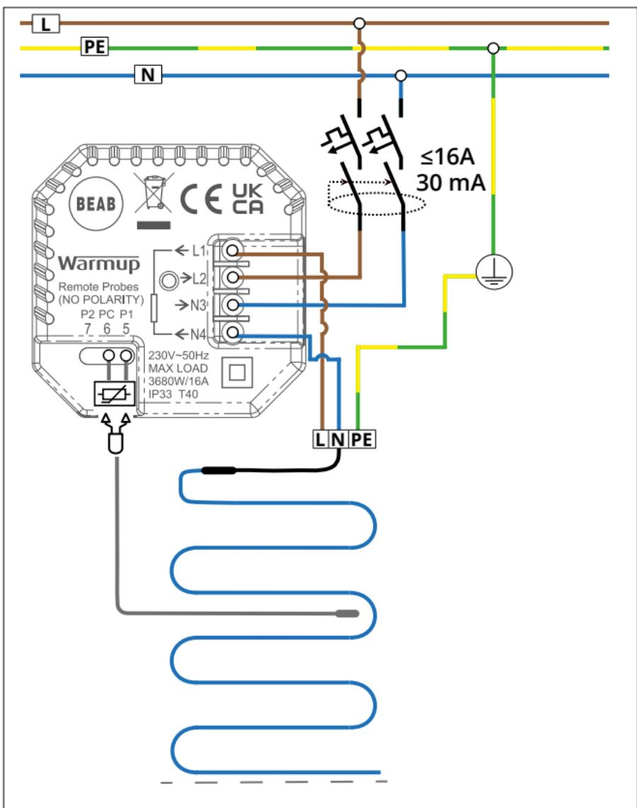
Οι θερμοστάτες Warmup είναι σχεδιασμένοι για μέγιστο φορτίο 16 amps (3680 W στα 230 V). Για έλεγχο φορτίων άνω των 16 amps πρέπει να χρησιμοποιείται ηλεκτρονόμος ισχύος.
