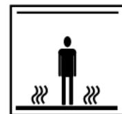
Ηλεκτρική καλωδίωση και πάνελ θέρμανσης εντός του δαπέδου. MHN διεισδύετε με καρφιά, βίδες ή παρόμοιες συσκευές. MHN περιορίζετε τη θερμική εκπομπή του θερμαινόμενου δαπέδου.
